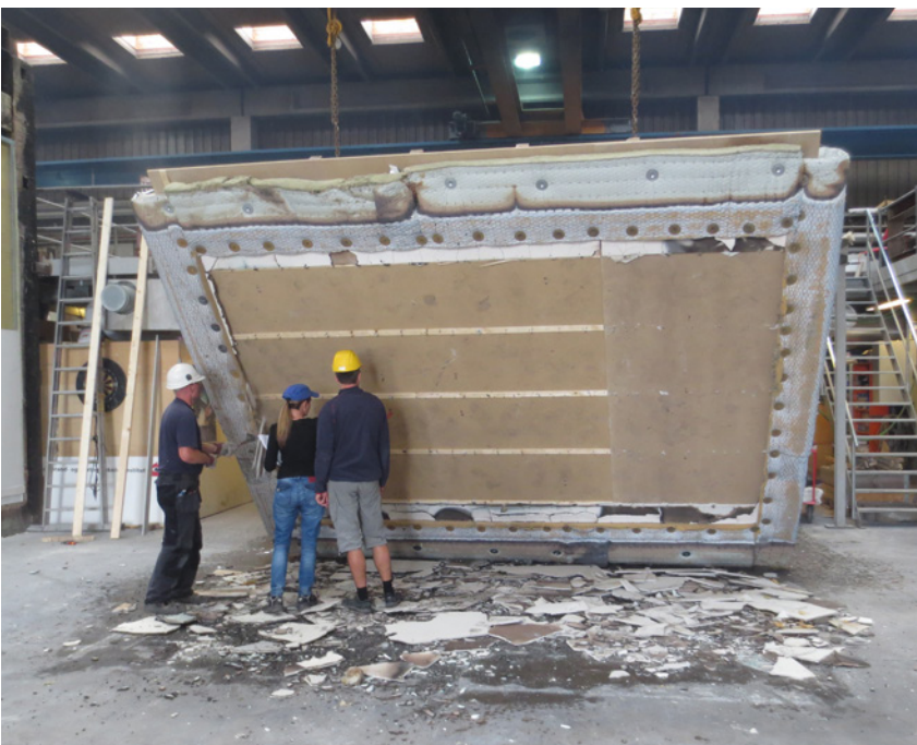
K 2 60 ehituskonstruktsiooni katse: kahekihilise fermacell® – kandepladi (indikaatorpladi) katsetamine
