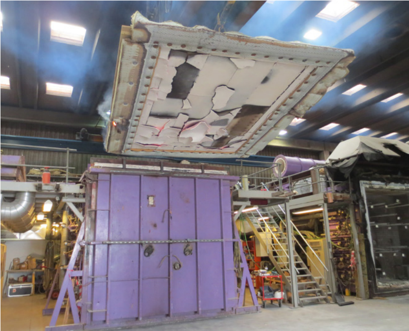
K 2 60 ehituskonstruktsiooni katse: kahekihiline fermacell® – 60 minuti möödudes
