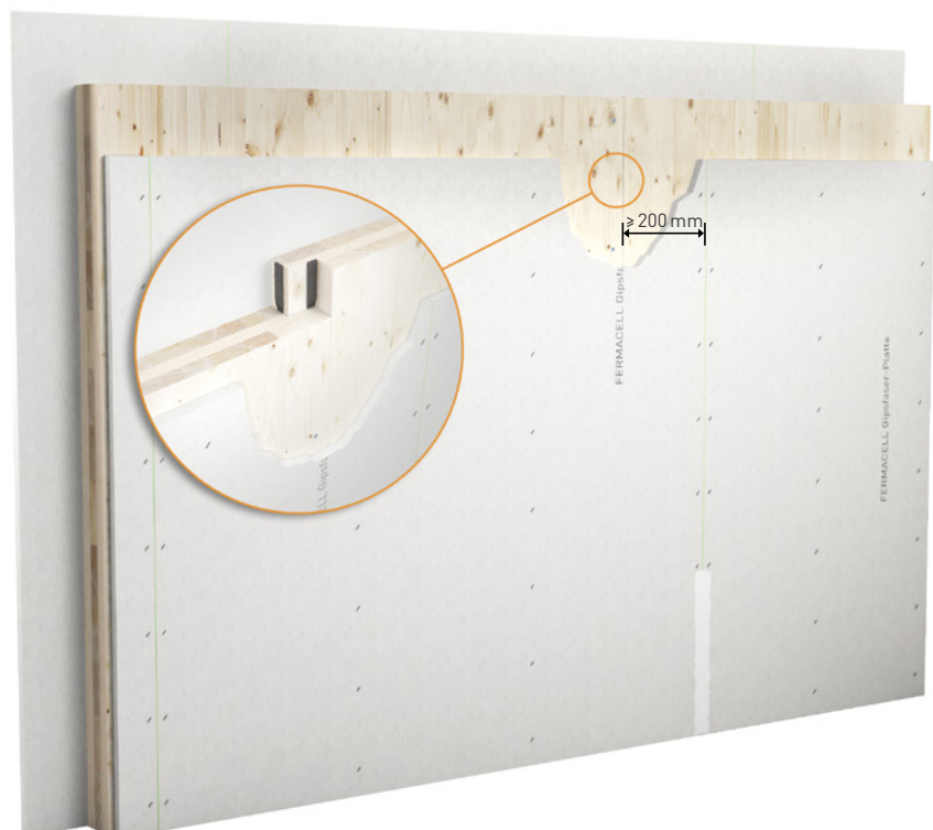
CLT-elementide liited – astmevaltsid
