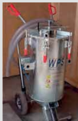
Mördipump vöö katmiseks mördiga
