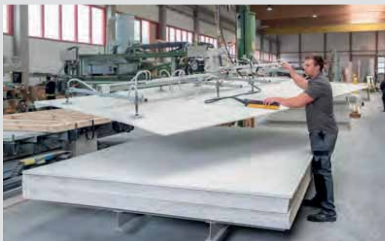
fermacelli kipskiudplaaside transportimine vaakumtõstukiga
