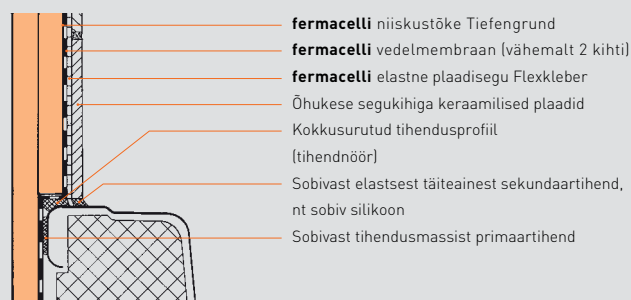
Ühendus Powerpanel H 2 O monteeritava seinaga, millel on läbivalt ühekihiline Powerpanel H 2 O vooderdis ja vannist kõrgemale paigaldatud topeltkiht
