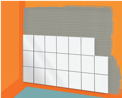
Joonis 6. Keraamiliste plaatide paigaldamine FERMACELLI elastse plaadiseguga Flexkleber varem täispinnaliselt tihendatud pinnale, kasutades õhukest segukihti (tihenduse viimine kooskõlla niiskuskooormusklassi A nõuetega)
